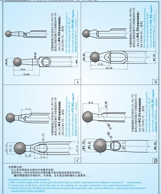
★.依圖依樣尺寸/公差/要求復合成型加工,可生產極為復雜、精密的柄部形狀。Compound contour machining according to the sizes/ tolerances/requirements of drawings and samples, we can produce extreme complex and accurate holder profile. 図面、サンブル、寸法または公差の要求により複合成型加工を行い、極めて複雑、精密な柄部の形状を生産できる.
