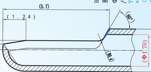
可精研磨柄之外徑( $\Phi$ 2.15~ $\Phi$ 2.35)/ $\Phi$ 2.20/ **$\Phi$ 2.25**(常備常規規格)
